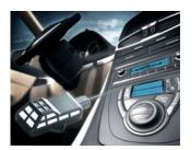
Der neue Climate Control Sensor (CCS) von Bosch misst den Kohlendioxidanteil (CO2) der Luft im Fahrzeuginnenraum. Das erlaubt eine erweiterte elektronische Regelung der Klimaanlage und senkt damit den Energiebedarf.
